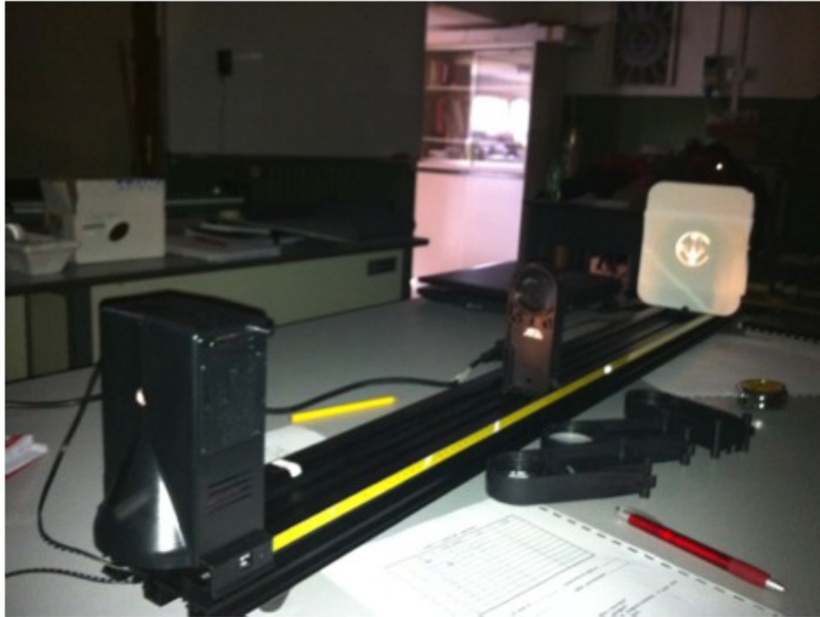
Figure 11: Strumentazione PASCO necessaria per la verifica della legge delle lenti sottili.
