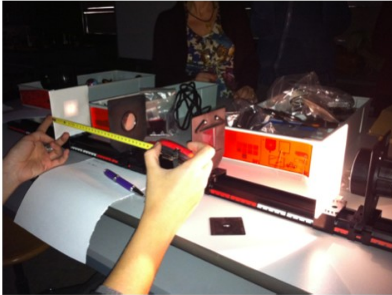
Figure 12: Strumentazione Leybold per l'esperienza delle lenti sottili
