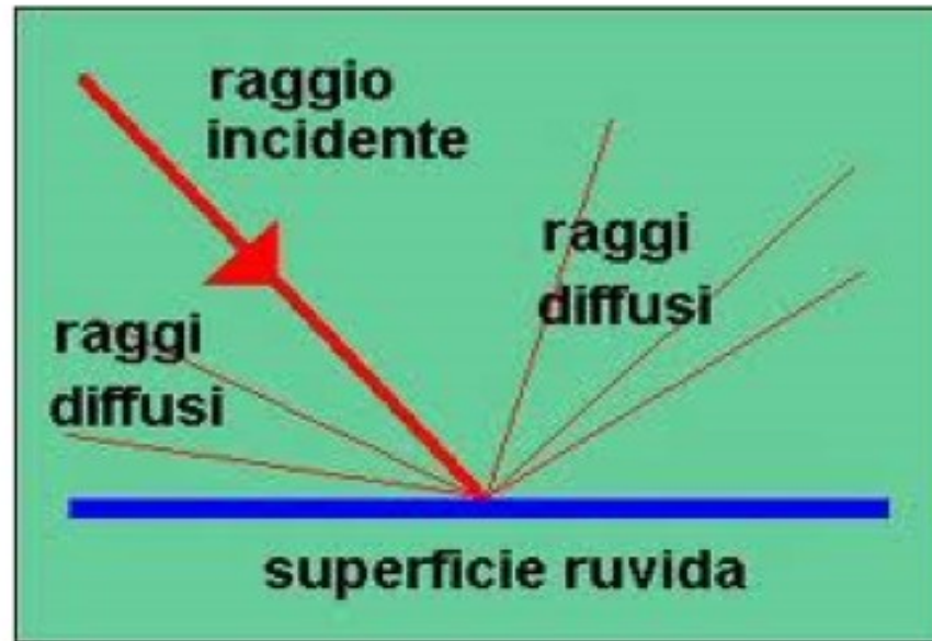
Figure 6: Rappresentazione schematica del fenomeno della riflessione e della diffusione da parte di un oggetto ruvido.
